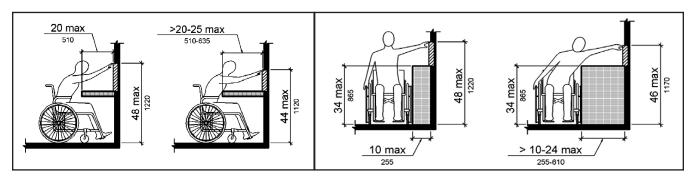
Nota de imagen: El rango de alcance se indica primero en pulgadas y luego en centímetros.
